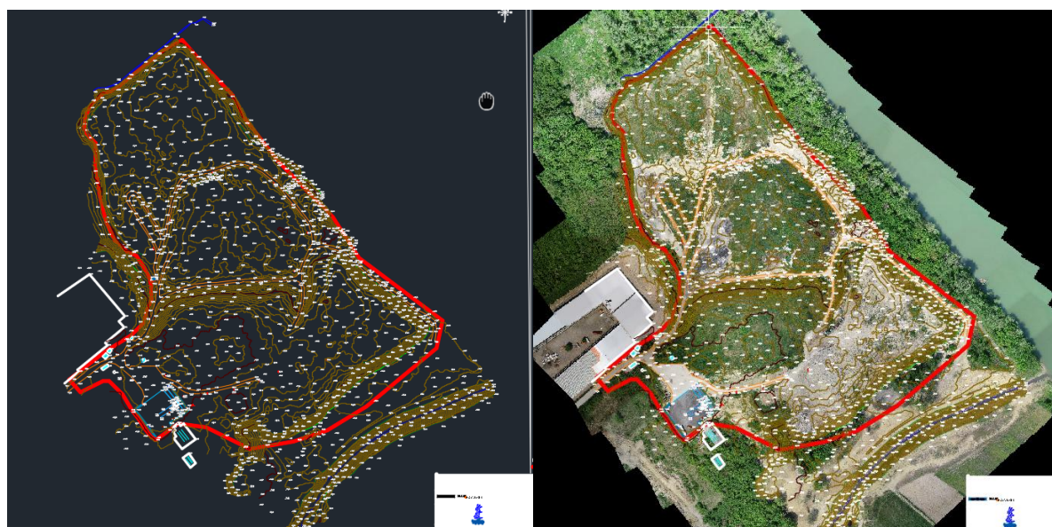
Slika 24 Topografija deponije Brčko na osnovu geodetskih mjerenja i visokorezolucijskih snimaka dronom (žičani model lijevo i snimci dronom desno)
